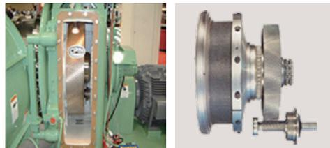
25馬力小型機から800馬力の大規模生産機まで CPM機はギア駆動方式を採用しています。ギアドライブによる安定したパワートランスミッションにより造粒しにくい原料の加工や、長時間の過酷な運転を可能にしています。100mmを超えたダイ厚の取付も可能。ベルト駆動方式に比べ10%以上の省電力。
