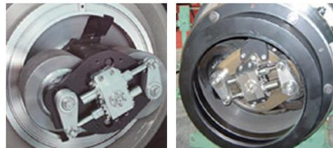
運転中にダイとロールのギャップを外部から自動調整できる装置です。エアモーターを採用した機械式のため、原料の流れ込むダイ内に油圧配管等がなく、故障が少ないのが特徴です。
