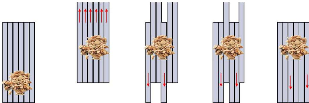
ムービングフロア（ウォーキングフロア）は、床面の板を油圧シリンダーでスライドさせ、貯留した原料を出口方向へ運び、定量供給する装置です。（容量は物質の流動性や形状によります）。
