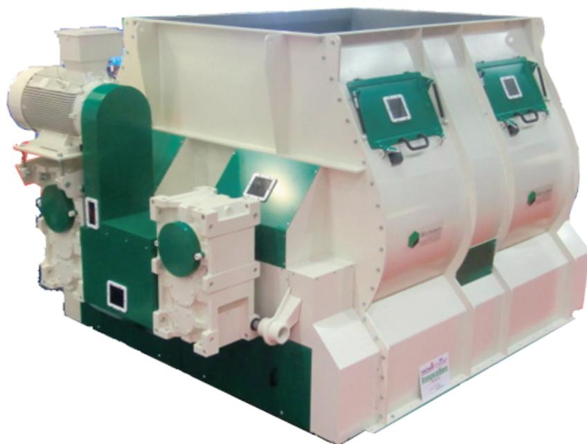
Wynveen社製 DPMA型2軸パドルミキサーは、2つのパドルの間で持ち上げられ完全に流動化した製品がぶつかり合うことで、他方式のミキサーと比べ短時間(30~60秒)で高い混合精度を実現します。
