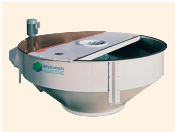
本機器中央部インレットより回転中の円形スクリーン上にペレットを搬入、粉はスクリーンをパスしリターンのルートへ、ペレット製品は製品タンクのルートへ排出されます。
