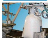
充填能力: 最大250内袋 (インナ-ライナー) が弛まない様充填前にエ アーを吹き込み充填後は排気します。
