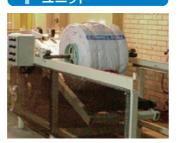
ロール状に巻き取られたフレコン バッグを自動で解きながら充填機へ と送ります。ロール状になったフレ コンバッグの装填は簡単に行えます。 ストックレール上には300袋以上の コンテナーバッグが装填可能です。
